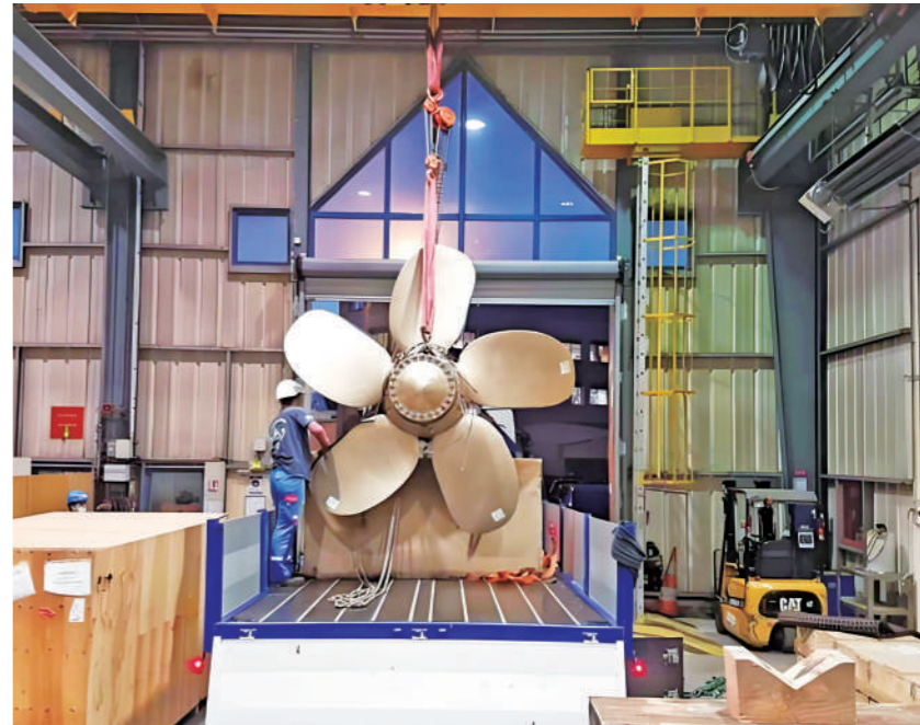
法国海军集团利用3D打印技术制造船用螺旋桨。
