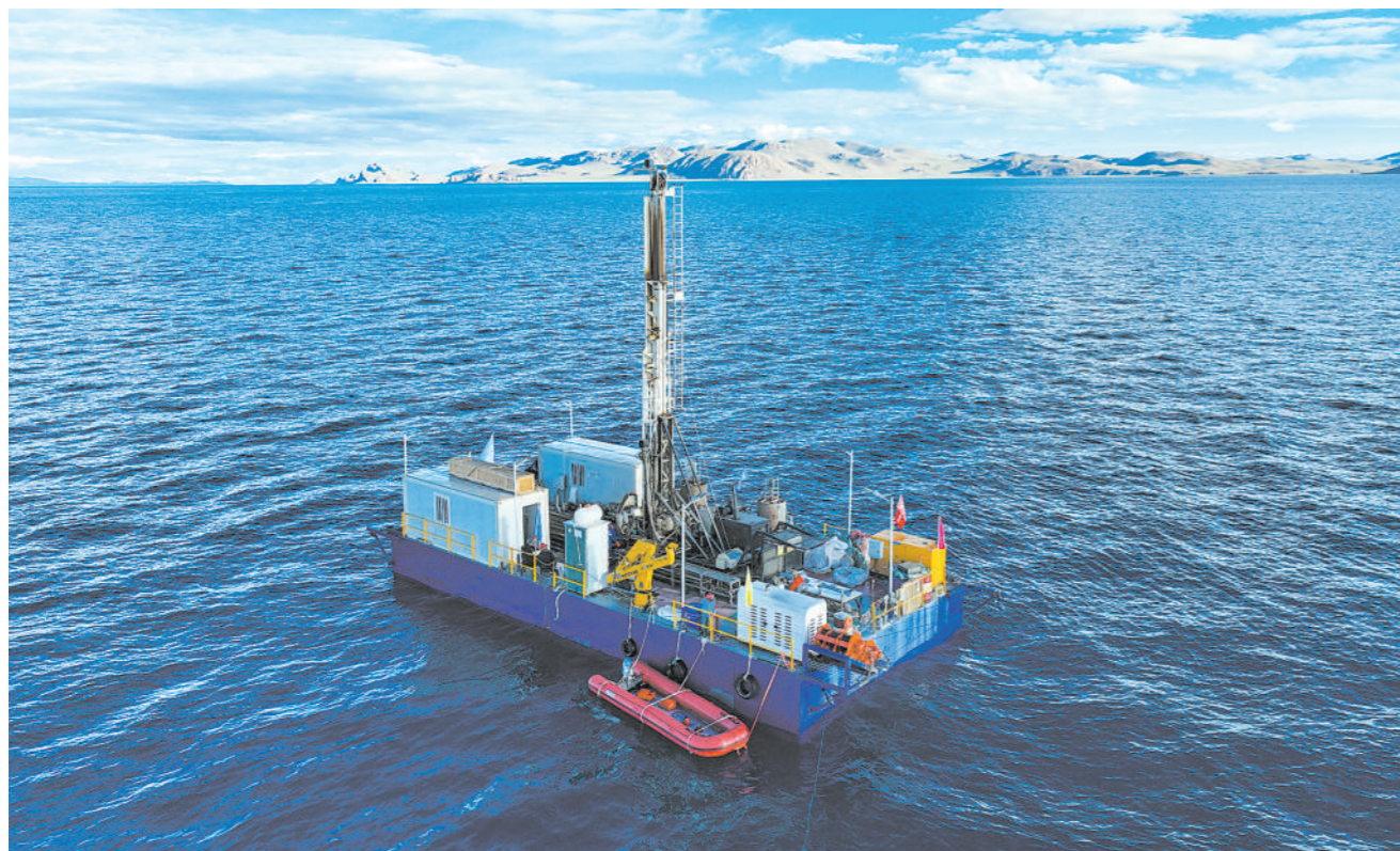
7月12日18时35分,在海拔超过4700米的纳木错中心湖区,多国联合科考队成功在湖底深度402.2米的地方获取了湖泊岩芯。这是我国首次在青藏高原大湖钻探中成功突破400米深度。图为纳木错水上钻探平台(无人机照片)。
