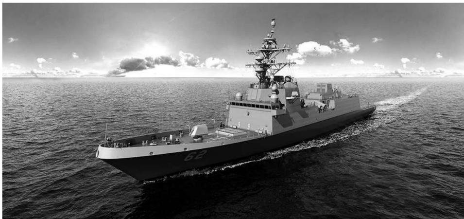
AN/SPS-73(V)18水面搜索雷达,AN/SLQ-61轻型拖曳阵列声呐,AN/SQS-62可变深度声呐等;可携带一架MH-60R海鹰直升机和一架MQ-8C火力侦察兵无人直升机。该舰主要用于进行防空、反潜、反水面作战、电磁战、监视和侦察行动。首舰原计划于2026年服役,目前美国海军已订购了6艘,其中1艘在建,计划总共建造20艘。
