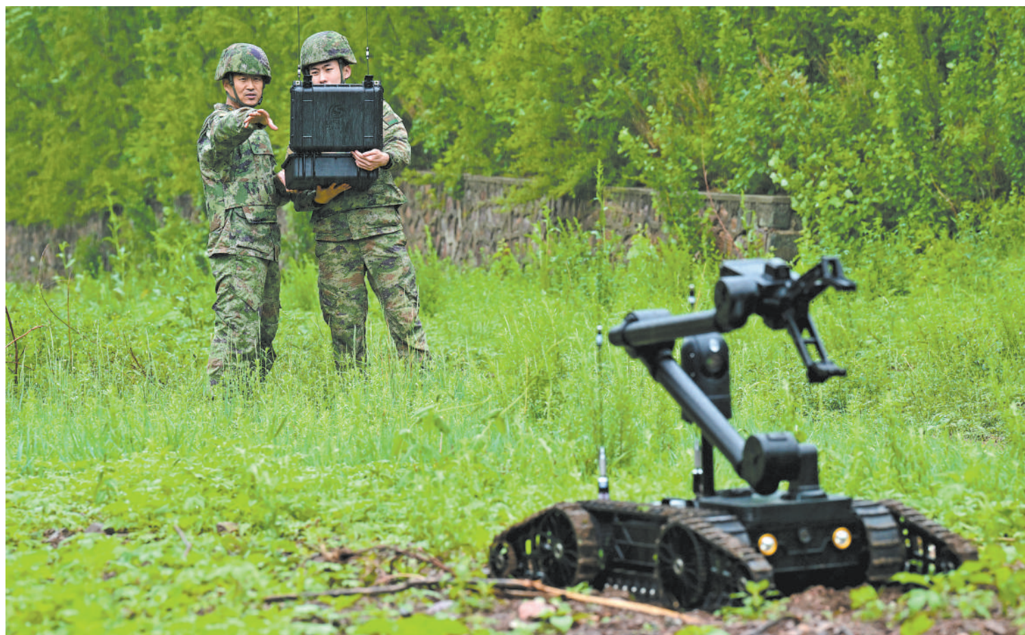
沈阳联勤保障中心某部注重运用新技术,提高报废弹药销毁效率和安全性。图为该部官兵在应急处训中,利用机器人对危险弹药进行识别和搬运。 孙卓文摄
