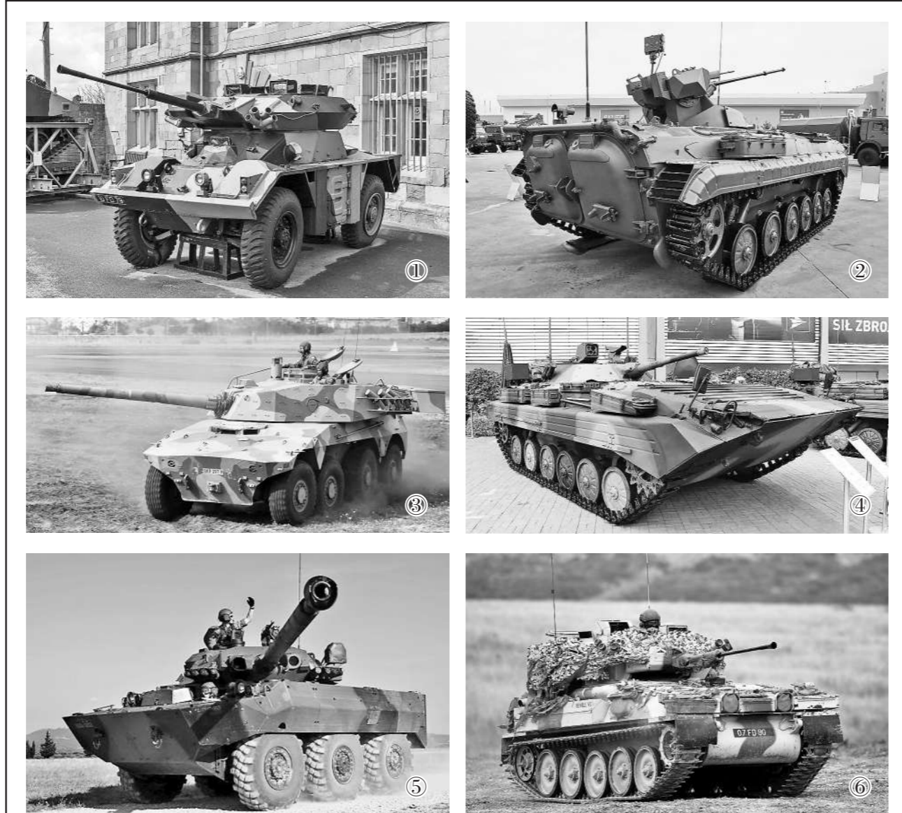
图①:德国的“狐”式装甲侦察车;图②:俄罗斯的BRM装甲侦察车;图③:南非的“大山猫”装甲侦察车;图④:波兰BWR-1D战斗侦察车;图⑤:法国的AMX-10RCR装甲侦察车;图⑥:英国的CVRT“弯刀”装甲侦察车。资料图片
