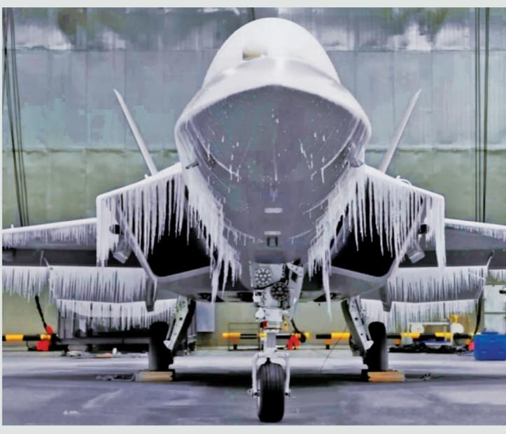
上图中这架挂满冰凌柱的战斗机,好像被施了魔法一般,冰封在机场的停机坪上。这是韩国KF-21战斗机的原型机在一处环境试验室中,接受极寒条件下冰冻测试的场景。
