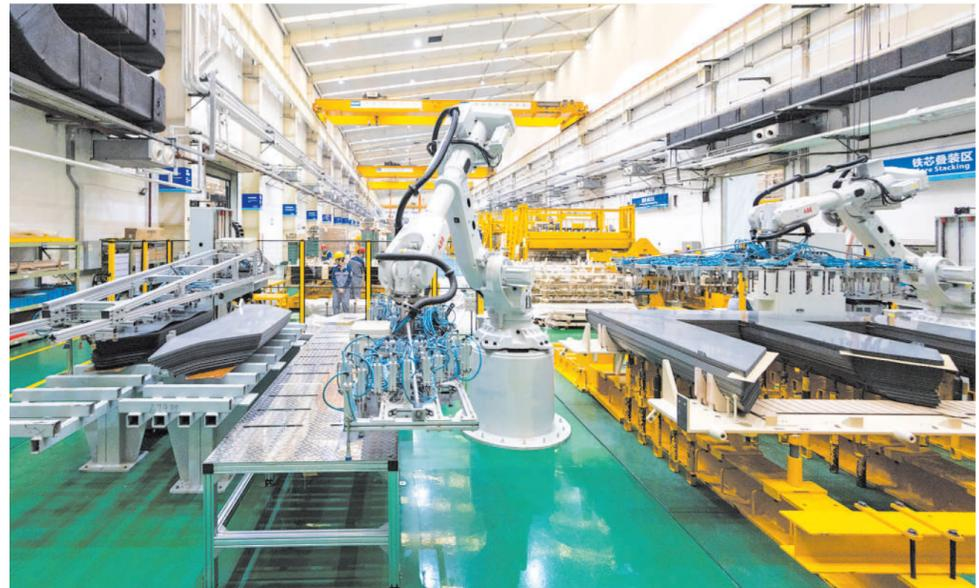
5月23日，在位于长三角G60科创走廊肇源地的上海松江，正泰电气变压器车间内的机器人把一层层薄为0.23毫米的硅钢片按设计要求叠装加工。
