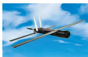
“郊狼”系列巡飞弹是美国雷神公司研发的低成本、多任务巡飞弹,外形采用矩形弹翼和V型尾翼设计,配有电动双叶片螺旋桨。
