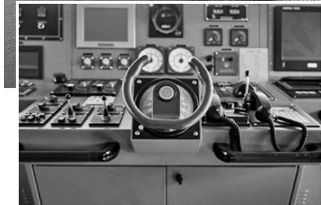
左图:“中国环监001”号船驾驶室,驾驶室中间就是比汽车方向盘还小的舵轮。图片由作者提供
