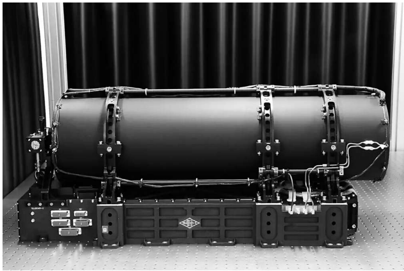
由中国科学院上海光学精密机械研究所制造的空间冷原子钟。 资料图片
