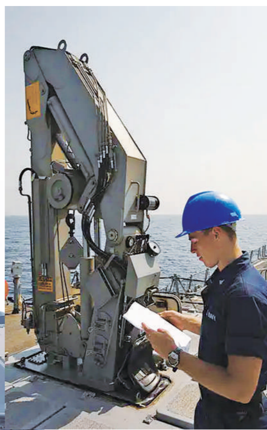
上图:MK-41垂直发射系统配备的再装填机构——一台折叠的伸缩式起重机。
