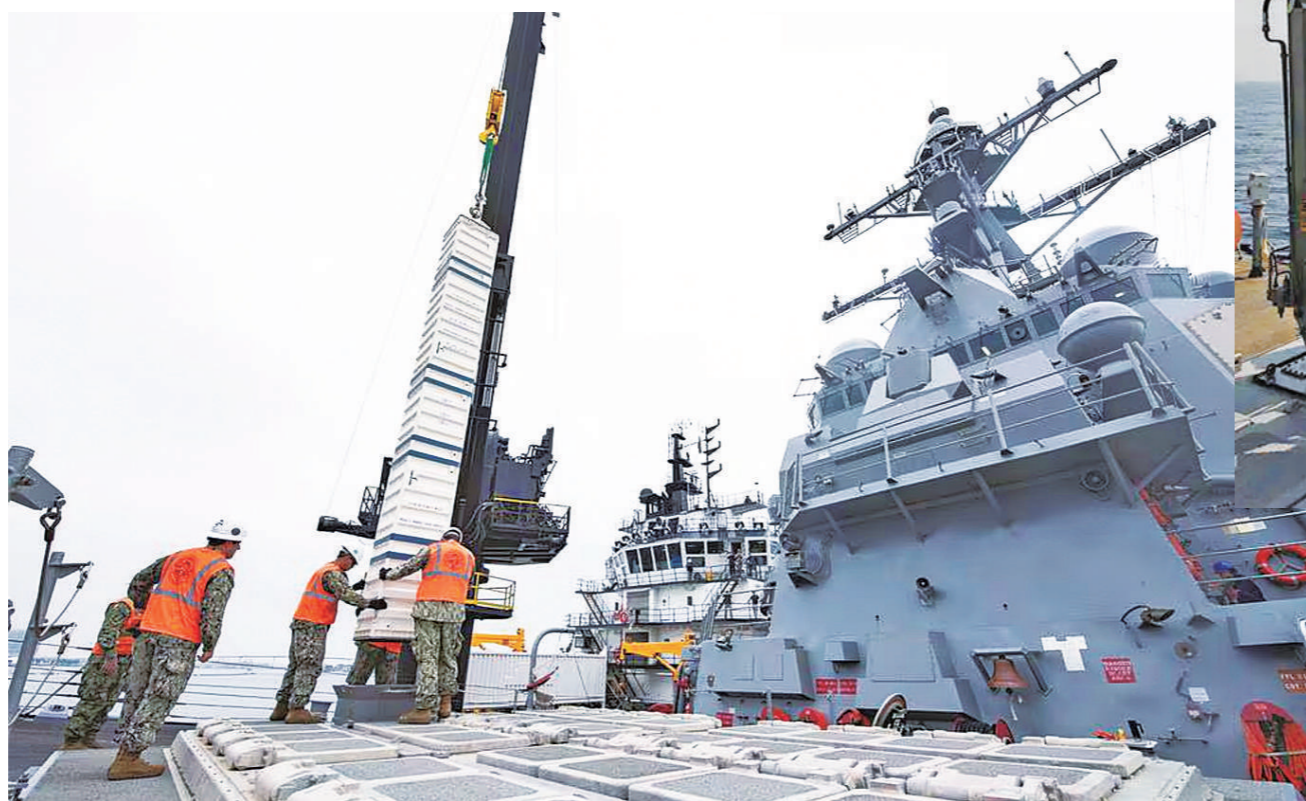
上图:MK-41垂直发射系统配备的再装填机构——一台折叠的伸缩式起重机。
