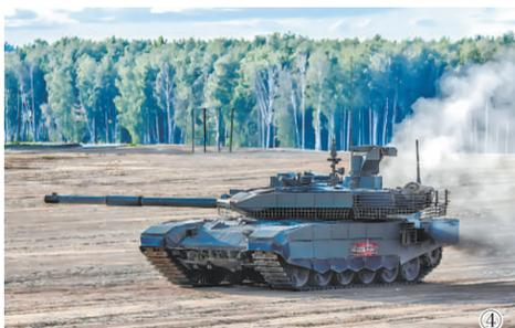
图①:加装反应装甲的T-80BVM坦克;图②:加装反应装甲的T-72B1坦克;图③:加装格栅装甲的“豹2”坦克;图④:加装格栅装甲的T-90M坦克。
