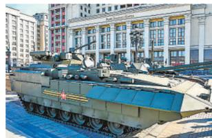
T-15步兵战车采用了与T-14“阿玛塔”主战坦克相同的通用底盘系统。车身整体使用高聚合物防护材料,使其获得了几乎与T-14相近的装甲防护能力。
