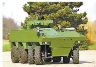
作为法国现役主力步兵战车,VBCI步兵战车源于20世纪90年代初法国提出的“模块化装甲车”计划。基于模块化设计,用户可根据任务需求进行武器系统改装和电子设备升级。“数字化战场管理系统”的加持,使该车可与其他战斗平台进行信息共享,战场态势感知能力得到提升。
