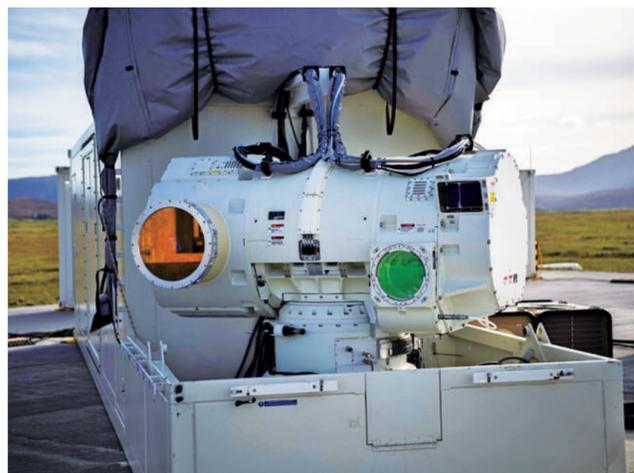
此前，“龙火”激光武器系统曾进行过静态高功率激光发射试验，以及跟踪空中和海上移动目标试验，展示了高精度跟踪能力。
