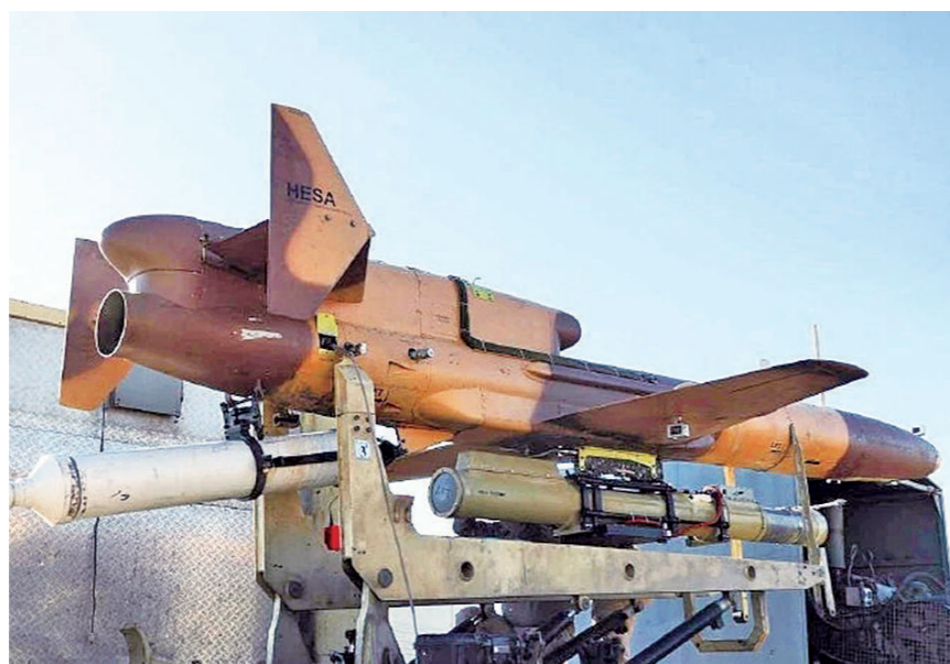
伊朗“卡卡尔”无人机搭载 AD-08“马吉德”导弹。
