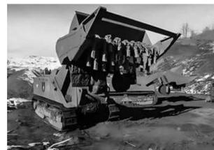
在“军队-2023”国际军事技术论坛上，俄罗斯乌拉尔车辆厂公开展示了UBIM装甲工程车。该车辆配备了一套便携式感应地雷探测器，能以12千米/小时行驶速度进行扫雷作业。
