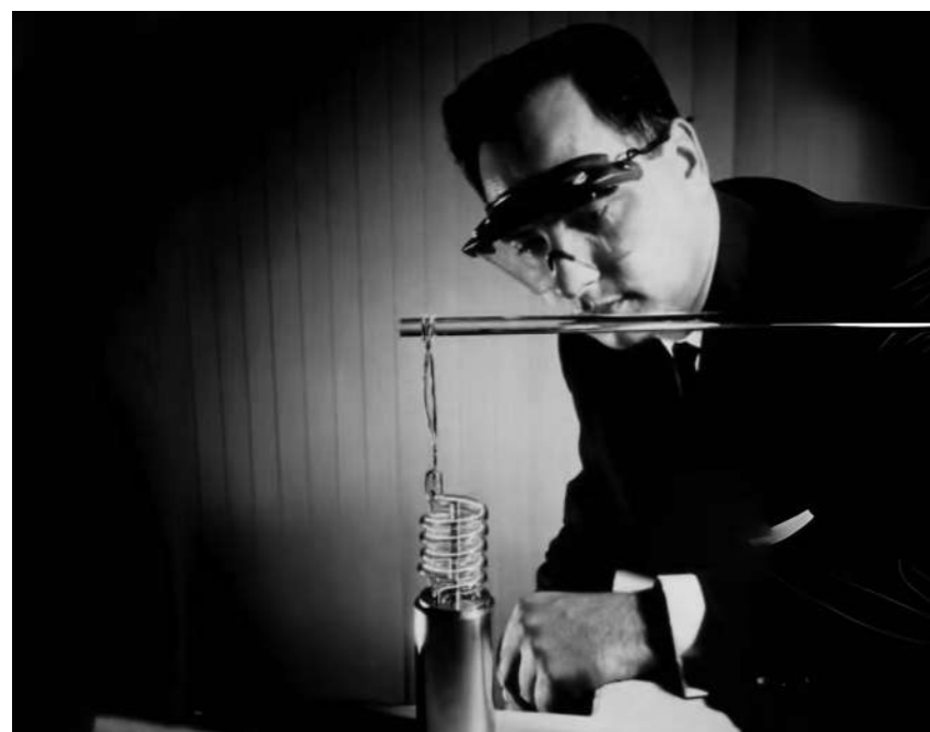
梅曼和他研制出的世界上第一台激光器——红宝石激光器。
