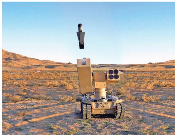
“巴坎-2”自主作战车辆发射激光制导导弹。
