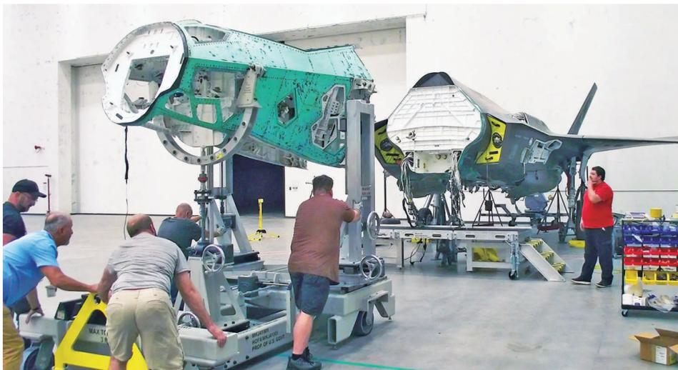
维修人员将F-35A“闪电II”多用途战斗机的机身与机头拼接在一起。
