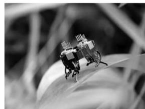
近日,科罗拉多大学博尔德分校研究人员研发了一种比蜘蛛体积还小的变形机器人,相关成果已发表于《先进智能系统》杂志。研究人员受蜘蛛启发,基于折纸设计和层压制造技术,将软体机器人的适应性与刚性机器人的敏捷性相结合,使得该机器人可在复杂的环境中奔跑,同时可实现变形全向移动操作。此外,这款机器人采用模块化设计,能够承载超过其体重3倍的额外有效载荷,同时行进速度可达每秒60毫米。同时,该机器人还可以通过挤压变形通过特定的狭小区域,进一步扩展其实际应用场景。据研究人员介绍,该机器人可在地震、坍塌等场景下更好地帮助救援团队寻找被困人员,还可应用于喷气发动机例行检查等工作。
