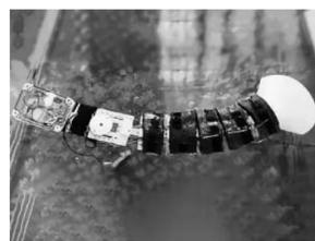
前不久,浙江理工大学研究人员设计了一款类似螳螂虾的水下机器人。据悉,研究人员受到螳螂虾的启发,根据螳螂虾多体节弯曲旋转和多腹足运动的特性设计了这款机器人。该机器人由4个部分组成,具有10个独立可控的仿生足以及一个基于绳驱动的柔性脊柱,具有游泳推进和身体弯曲功能。研究人员通过结合绳驱动、柔性脊柱以及中框模式发生器控制,成功模拟了螳螂虾的运动方式。这种运动方式不仅提供更大的正向推进力,还能大大减少恢复时受到的正向阻力,提高机器人的机动性和灵活性。据称,该机器人未来可用于代替人类完成危险作业,如探索狭窄空间等未知环境。此外,这款机器人还能在实现集群协作高效作业方面发挥重要作用。
