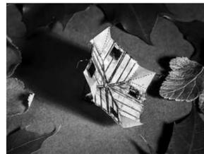
近期,华盛顿大学的研究人员开发出了一款可变形折纸微型飞行器,相关成果发表于《科学机器人》杂志。通过预定义的折痕线,微型飞行器的面积、受到的风阻发生改变,从而影响它的飞行方式。受此启发,研究人员研发出了一款不装电池,仅靠太阳能驱动的酷似树叶的微型机器人。研究人员通过设计一种低功耗的柔性电磁制动器,实现了该机器人的飞行功能。通过在折纸结构上制作集成电路,并由太阳能供电,该机器人在微风下的最大航程可达98米,还可以通过蓝牙连接实现60米范围内的无线数据传输。据悉,该机器人既可以单独使用,也可批量空投到各个区域,应用于收集信息、搜寻搜救、大规模环境监测等场景。
