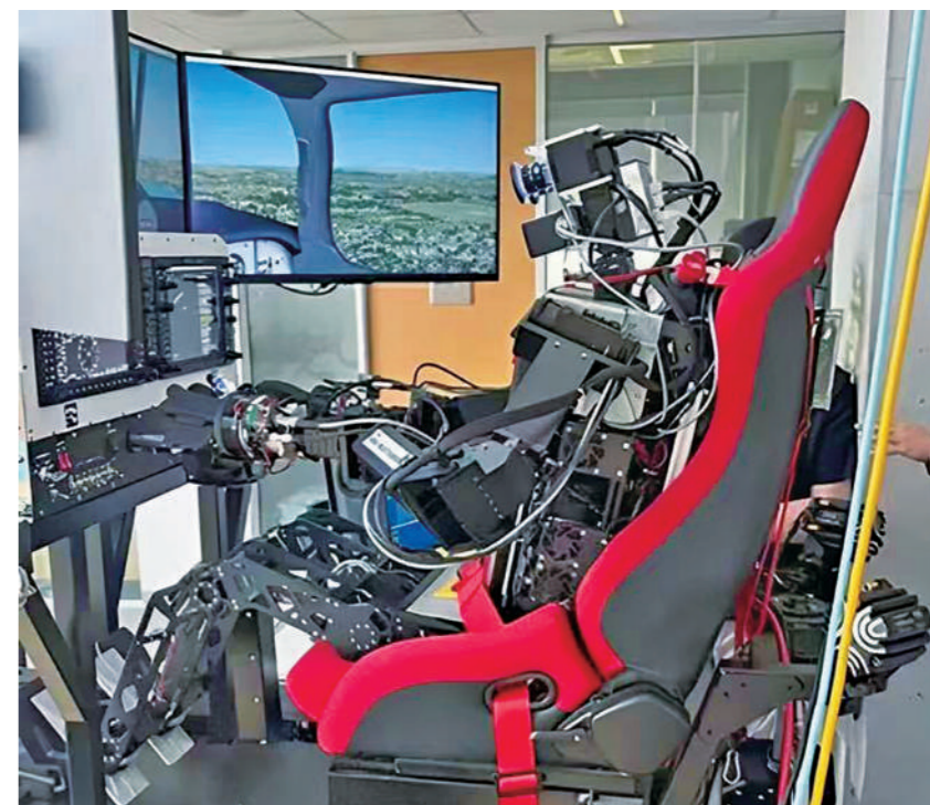
韩国科学技术高级研究所研发的人形机器人操作飞行模拟器。
